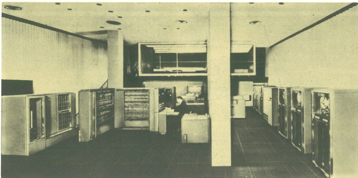
L'IBM 704 aveva una memoria centrale di 32 K words, ciascuna delle quali era di 36 bit. Pur essendo dotato di periferiche come lettore di schede, perforatore, stampante, unità magnetiche e display video, non realizzava la simultaneità di operazione di I/O e di calcolo interno.
